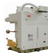
Para hasta 1.000.000 de operaciones eléctricas y mecánicas, clase de tensión hasta 12 kV y corriente nominal de 400 A. Disponibles en las versiones fija y extraíble y con base fusible. Fabricados y probados de acuerdo con la Norma IEC62271-100.
