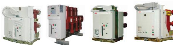
VD4 - Interruptor con botellas de corte en vacío encapsuladas y mecanismos de operación para 30.000 operaciones mecánicas y eléctricas. Cubre las diferentes aplicaciones de operaciones de cargas en corrientes de corto circuito de hasta 50 kA, tensión nominal de hasta 36 kV y corriente nominal hasta 4000 A\* (\*con ventilación forzada).
