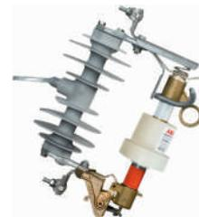
Seccionalizador electrónico para uso en líneas aéreas de hasta 38 kV, con apertura monofásica o trifásica para protección y aislamiento de las redes. Probado y producido de acuerdo con la Norma ANSI/IEEE C37.63, opera en coordinación con el dispositivo de reconexión y diferencia fallas transitorias de fallas permanentes.
