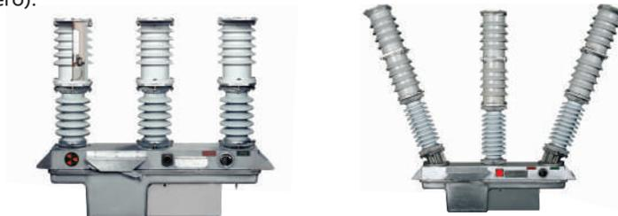
Varmaster VBM 15 - 69kV: corriente continua de hasta 600A, corriente de corto circuito de 20kA. Pueden ser monofásicas o trifásicas, mecanismo de operación por solenoide o motor, ofrecen 100.000 operaciones libres de mantenimiento, no utilización de aceite y gas, VBU 69 - 230kV: corriente continua de 600A, corriente de corto-circuito de 40kA.
