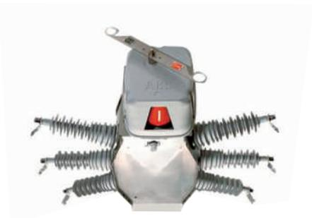
Seccionador de tres posiciones con aislamiento en gas, desarrollada para soportar la apertura bajo carga en líneas aéreas de distribución de 24 y 36 kV. Posee un recinto de acero inoxidable, resistente a la corrosión y herméticamente sellado, lo que posibilita una operación confiable sin necesidad de mantenimiento, incluso en las condiciones climáticas más severas.
