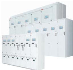
Son unidades funcionales a prueba de arco interno IAC AFLR. Poseen compartimentos segregados, por medio de particiones metálicas LSC2B. Probados y producidos de acuerdo con la Norma IEC62271-200.
