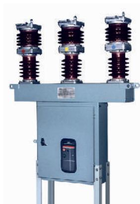
Interruptor en vacío de media tensión, tanque vivo para instalación exterior de corriente nominal externas de hasta 40,5 kV, con capacidad en régimen continuo de 2500 A y de apertura en hasta 31,5 kA. Fabricados y probados de acuerdo con la Norma IEC62271-100.
