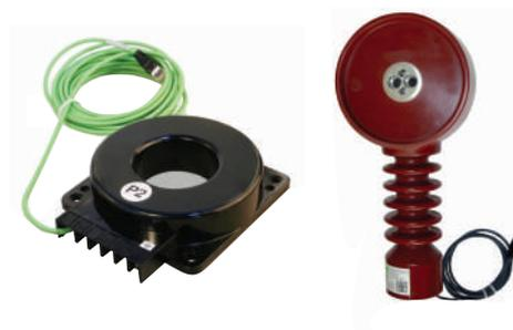
Ofrece una medición lineal sin saturación en eventos de falla, su construcción permite un ajuste de corriente variable de 4 a 1250 A, con conexión RJ45 que facilita la conexión al relé y la señal de salida de 180 mV. Tensión nominal de 750 V hasta 24 kV, de acuerdo con el modelo.
