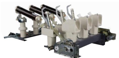
**Gsec** - Seccionador para operación bajo carga con tres posiciones, capacidad de corriente de corto circuito hasta 20 kA, tensión nominal hasta 24 kV y corriente nominal de hasta 1250 A, disponible en versiones de resorte simple o doble, y con base fusible.
