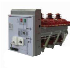
El seccionador Gsec/IB se entrega con un contador de operaciones, contactos auxiliares 4 NA + 4 NF, kirk, base para fusibles, indicación de fusión de fusibles, lámina de conexión a tierra directo en la base (no incluye fusibles).
